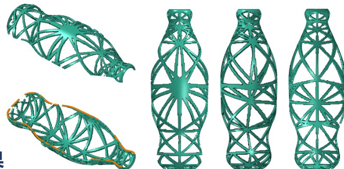
联系：加筋设计可以理解为蒙皮固定的拓扑设计
