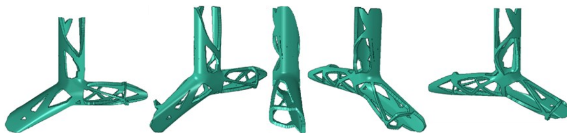
图 5.33 三通管道非对称算例的最终设计
