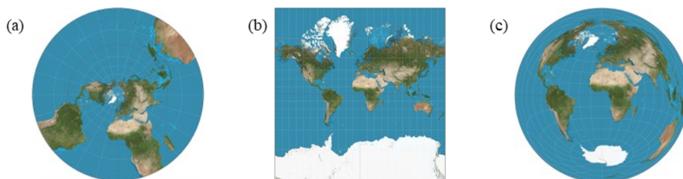
图 1.19 地图绘制中的不同投影方法：(a) 球极投影；(b) 墨卡托投影；(c) 兰伯特方位等积投影
